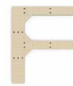
PONTON EN FORME DE F, 9 M DE LONG ET 7,6 M DE LARGE
